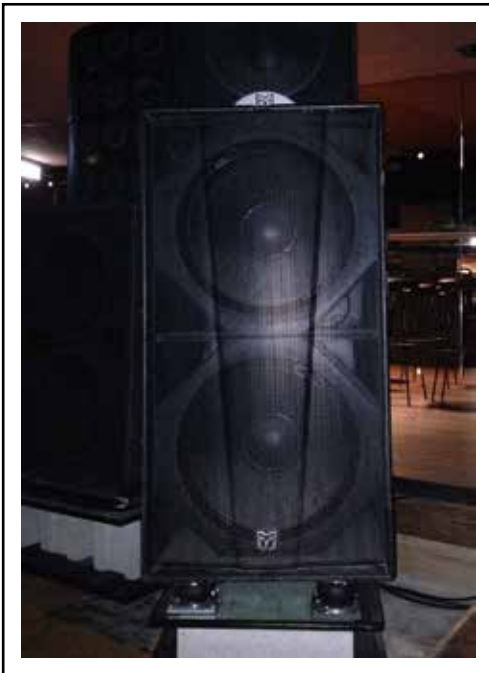
重低音音響安裝YS-K氣墊式避振器
